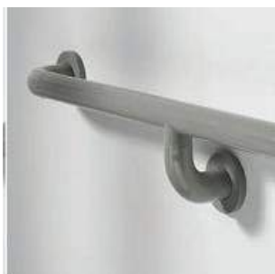
COD. PMU001 - CORRIMANO TUBOLARE Ø46 IN ALLUMINIO RICOPERTO IN POLICARBONATO - FINITURE/FINISHES: VEDI SCHEDA TECNICA. - QUANTITÀ MINIMA: 4 MT
